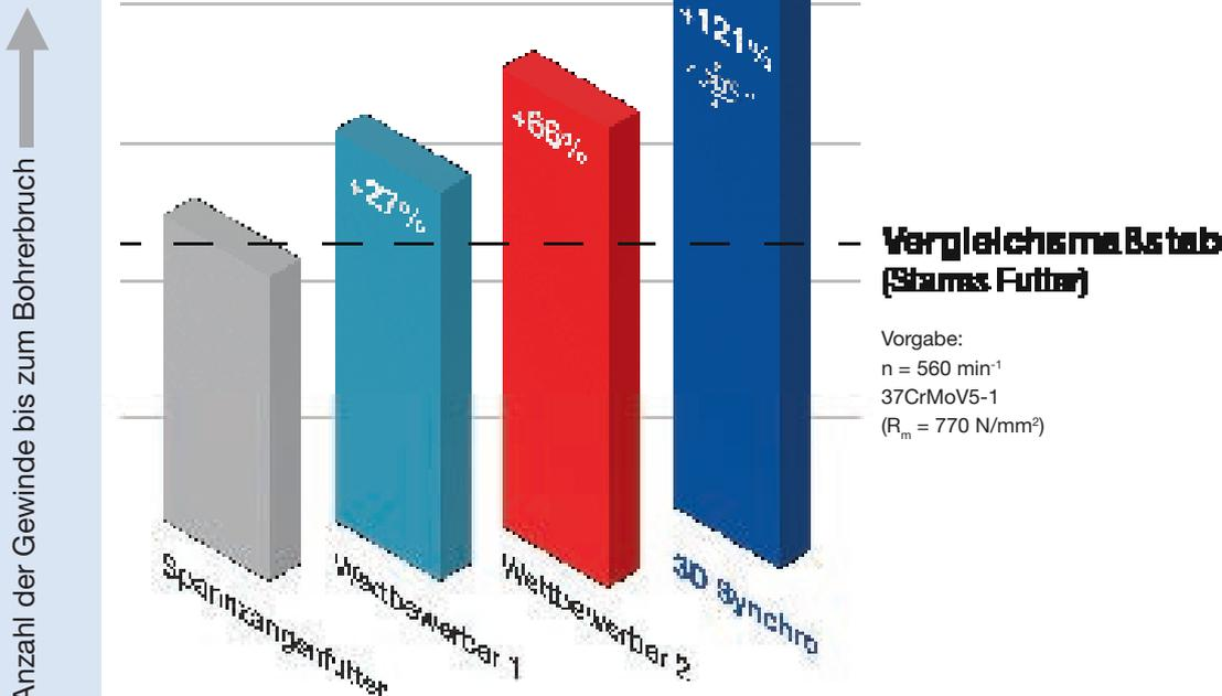
\*1 220% Standmenge des M8 Gewindebohrers beim Dauerversuch mit  $n = 560 \text{ min}^{-1}$  in X37CrMoV5-1 ( $R_m = 770 \text{ N/mm}^2$ ) mit dem S3D Synchrofutter im Vergleich zu 100% Standmenge mit einem Standard-Spannzangenhalter.
