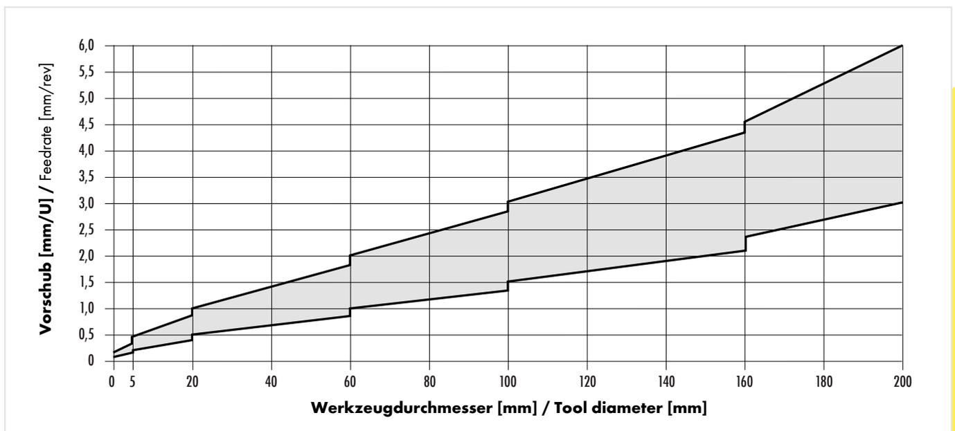
Drehzahl und Vorschub stehen in Abhängigkeit von verschiedenen Parametern, wie z. B. Kühlung, Aufspannung, Werkstoffkennwerte etc.
