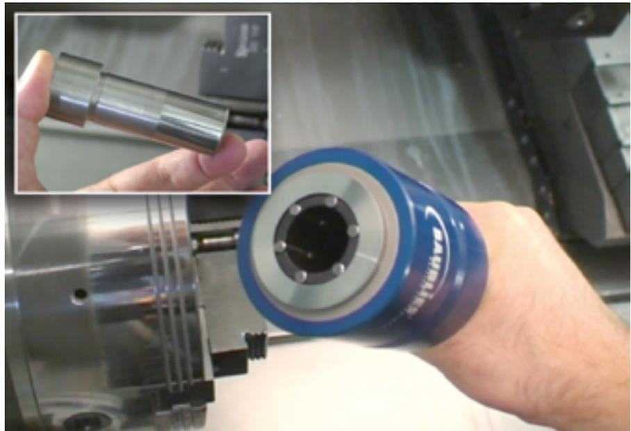
Werkzeug zur Bearbeitung von zylindrischen Außendurchmessern.
