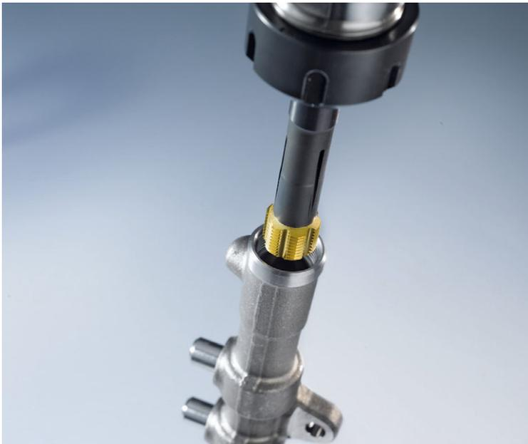
**Railrohr oder Injektor (Automobilindustrie)**
