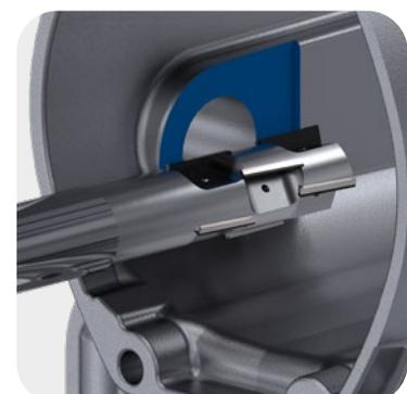
**4+5 PKD-Stufenwerkzeug zur Bohrungsinnen-, Planspiegel- sowie Rückwärtssenkbearbeitung.**
