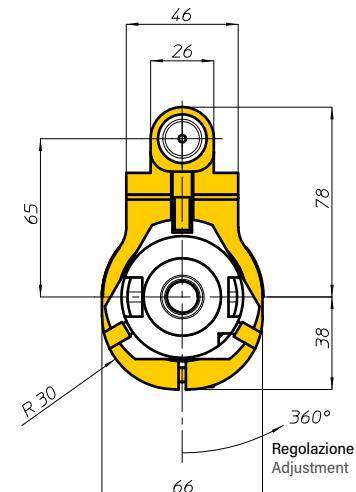
Il gruppo antirotante ricopre una funzione di fondamentale importanza nella qualità di lavorazione della testa ad angolo. Per questo motivo i tecnici della OMG hanno studiato e messo a punto un antirotante di nuova concezione i cui punti salienti sono:
