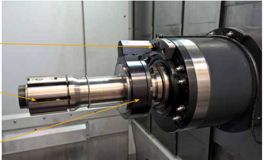
**Die PE-Wandler Baugruppe** sollte so nah wie möglich an der Spindelnase sein, um für die Messung die Luftsäule so kurz wie möglich zu halten.
