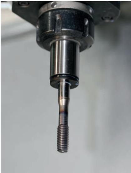
Der neue STA Synchronieinsatz (Synchro Tapping Adaptor) wurde speziell für Spannzangenaufnahmen entwickelt und ermöglicht das Gewindenbohren und -formen auf Maschinen mit synchronisierter Spindel.
