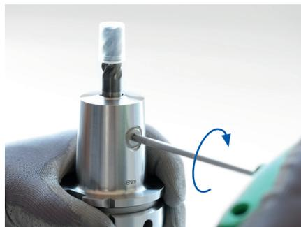
5. Einen Drehmomentschlüssel auf das angegebene Anzugsdrehmoment (siehe Tabelle "Anzugsdrehmomente der Spanschraube" auf Seite 7) einstellen.
