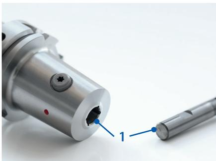
1. Die Aufnahmebohrung und den Werkzeugschaft reinigen (Position 1).
