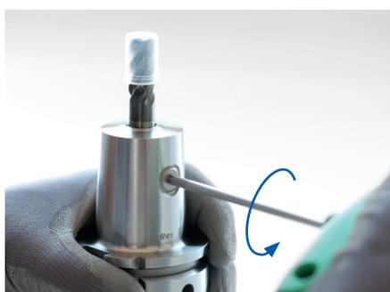
1. Die Spannschraube durch Drehen gegen den Uhrzeigersinn lösen.
