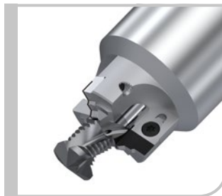
Kombinationswerkzeug mit Bohrgewindefräser M 16 x 1,5 mit IK-Austritt in den Spannuten und drei PKD-bestückten Konturplatten
